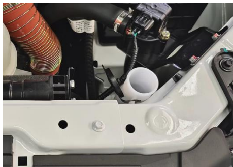
รูปที่ 88 : การเปิดถังเก็บน้ำยาล้างกระจก
