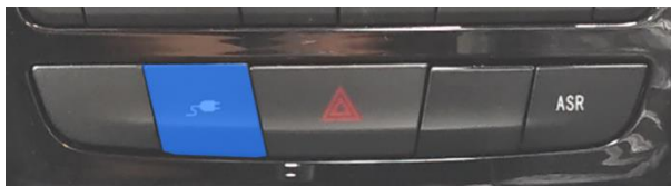
รูปที่ 75: ปุ่มเปิดฝาคอครอบช่องชาร์จ
