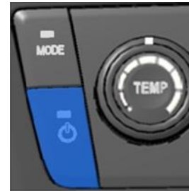
รูปที่ 39: ปุ่มควบคุมระบบปรับอากาศ (A/C system)
