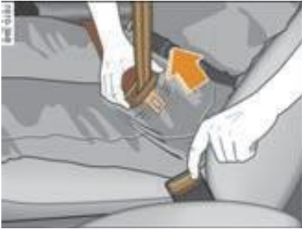
รูปที่ 67: การปลดตัวล็อกจากเข็มขัดนิรภัย
