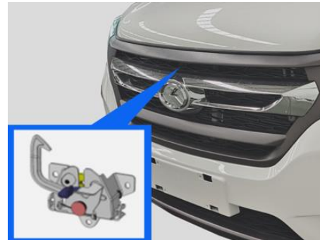
รูปที่ 83 มือจับสำหรับเปิดที่อยู่ใต้ฝากระโปรงหน้ารถ
