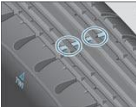
รูปที่ 90: เครื่องหมายแสดงการสึกหรอของดอกยาง
