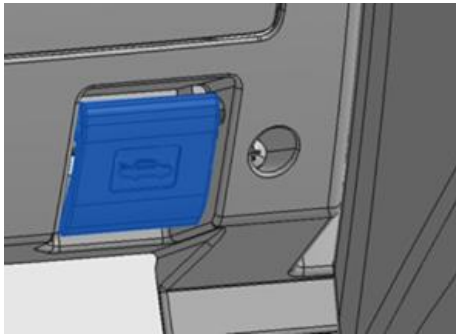
รูปที่ 82 : แสดงตำแหน่งที่จับ เปิดฝากระโปรงหน้าอยู่ทาง ขวาของผู้ขับขี่
