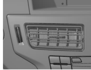
รูปที่ 53 : การปรับทิศทางช่องระบายอากาศ ②
